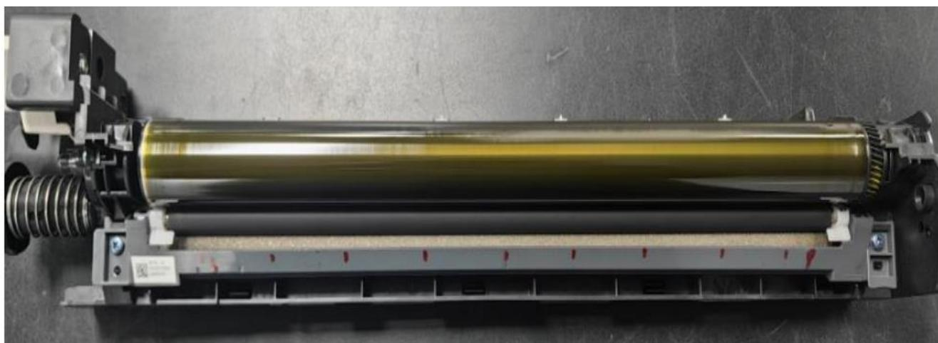
Отличное состояние PCR и драм-юнита после испытания
